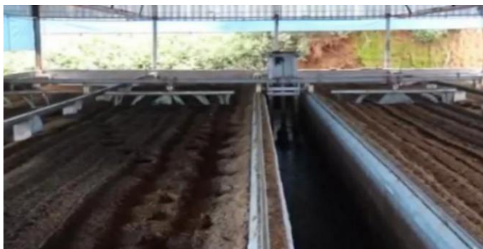
异位发酵床自动喷淋示意图
