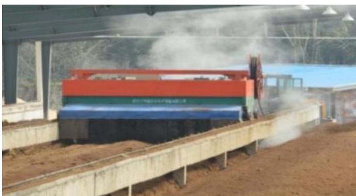
异位发酵床翻抛蒸汽示意图
