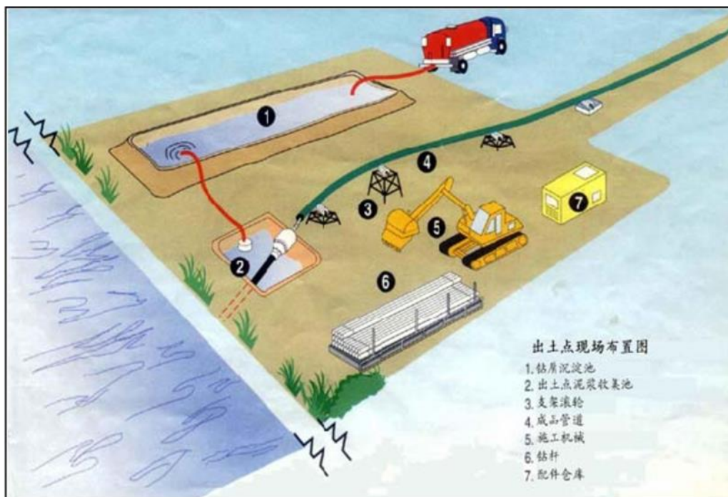
图 2.2-5 定向钻出土场地示意图
