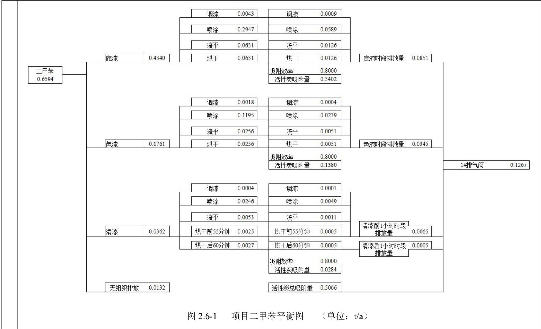
图 2.6-1 项目二甲苯平衡图 (单位: t/a)
