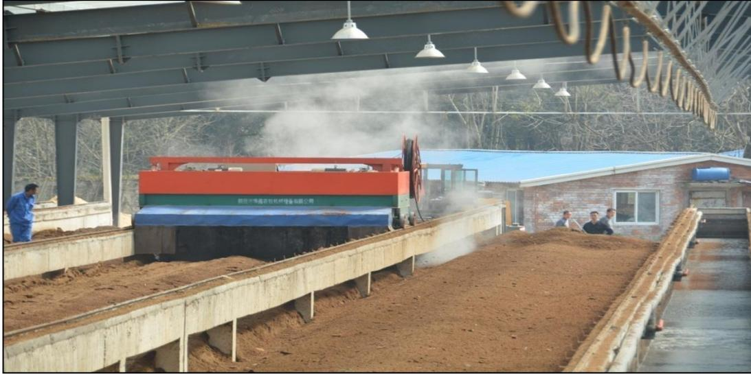
图 5.2-7 异位发酵床翻抛蒸气案例示例
