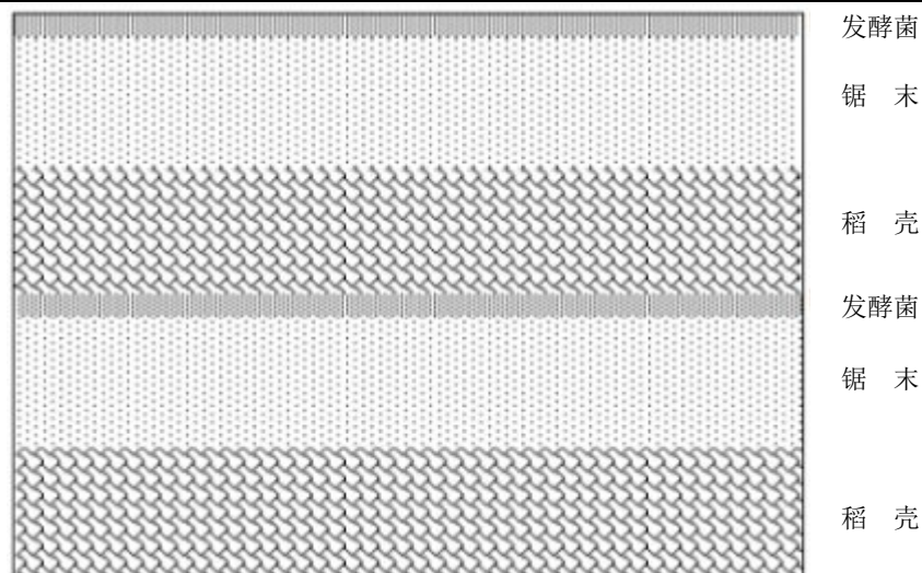
图 2.4-3 异位发酵床垫料翻抛前铺设剖面示意图
